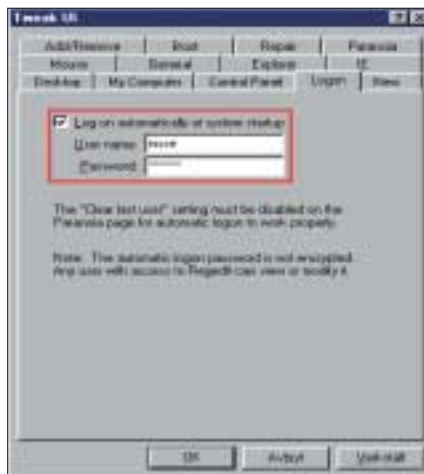
Bild 6. Automatisk inloggning i Windows 9x och 2000 mot specifik användare med hjälp av Tweak UI.
