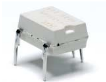
Bild 3. Det halvledarrelä som tillsammans med ett motstånd kunde skapa det spänningsfall som krävdes för att få igång systemet.
