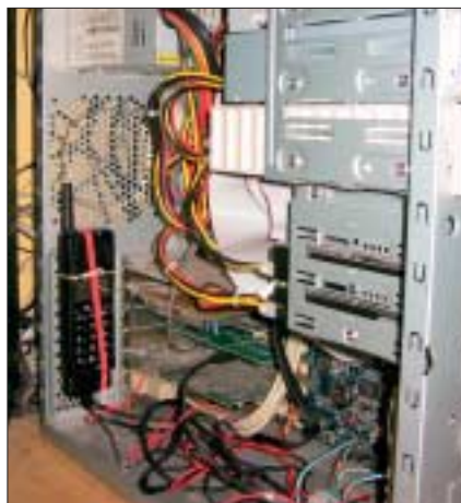
Slutresultatet: Med en mobiltelefon innanför chassit kan man ringa upp och starta datorn med en enda ringsignal. Två signaler stänger av datorn om den skulle hänga sig.
