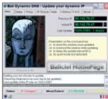
Bild 12. Med hjälp av DynDNS och ett program som Bali Dynamic DNS har du alltid tillgång till din dators IP-adress även om den tilldelas dynamiskt.
